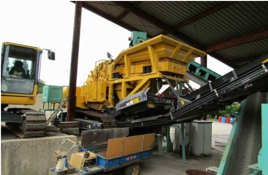
破砕機で破砕 破砕後、磁選機で金属を除去 ・コマツBR250G
