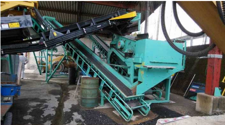
スクリーンで選別 ・中山鉄工所NH S482 ・40mm、30mmの2段 (製品サイズはレバーで切替) ・40mmオーバーサイズは 破砕機へベルトコンベアで リターン
