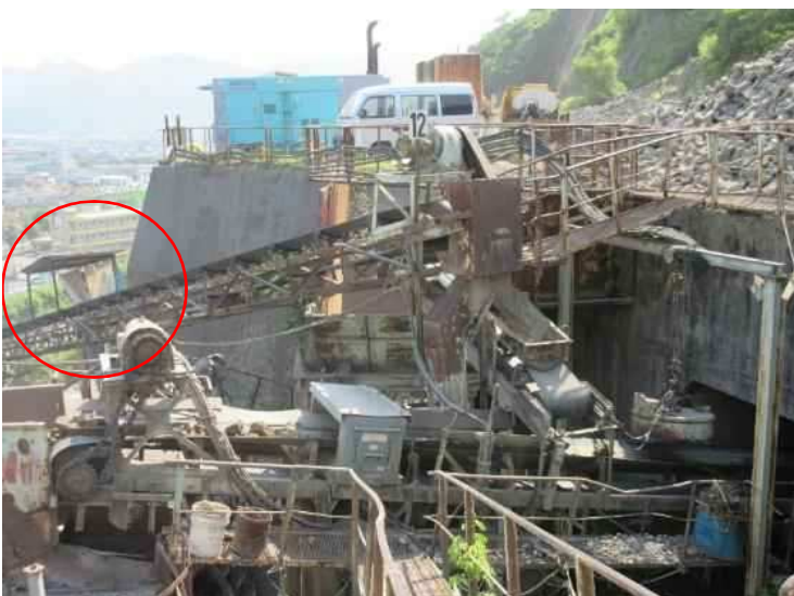
人手による異物除去 * オーバーサイズ戻り時に アルミ等除去
