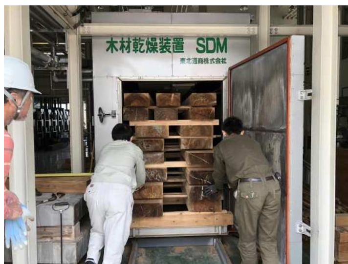
ツーバイフォー工法部材の乾燥試験 （県単試験事業）
