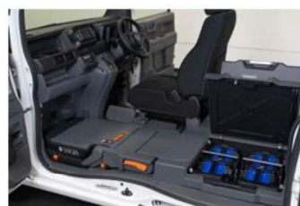
交換式バッテリーを搭載した車内
