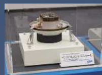
①インストルメントモジュール カプセル本体部分。リュウグウサンプルを入れておくため円筒状のサンブラコンテナ、パラシュート等が収められていた。
