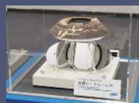
④背面ヒートシールド カプセルの進行方向反対側を守っていた。前面ヒートシールドと同じく降下中に分離された。
