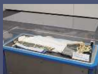
③パラシュート 強く軽いポリエステル製の十字形のパラシュート。予定通り上空約5kmで開き、十数分かけて着地した。
